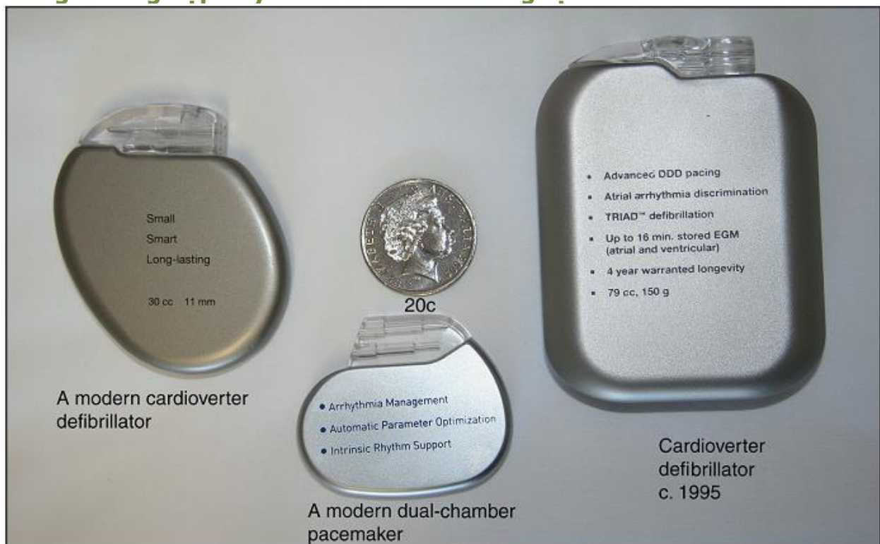
Hình 8.13. Máy tạo nhịp và khử rung.
