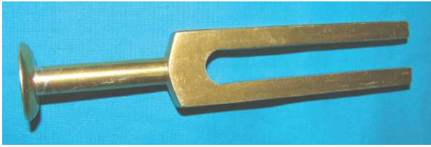
Fig. 1.7A: Hartmann tuning fork
