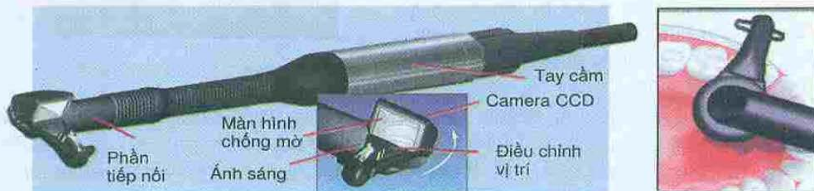
Hình 7.9. Sử dụng DIFOTI: Soi ở mặt ngoài, nhận hình ảnh ở mặt trong
