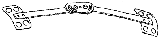
Hình 42-26. Khớp kim loại dùng trong bột khớp đùi cẳng chân. Có hai trục chuyển động giúp cho trục khớp di chuyển dễ dàng khi bệnh nhân gấp duỗi gối. Có chốt khóa để định trước biên độ cho phép vận động khớp.
