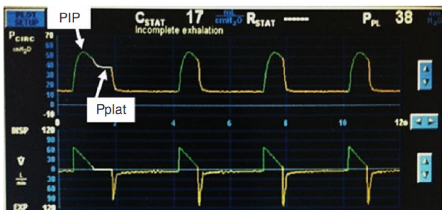
Hình 5.5 Màn hình thông khí cho thấy mối quan hệ giữa áp lực hô hấp đỉnh (PIP) và áp lực cao nguyên (Pplat.) Pplat chỉ được nhìn thấy bằng thao tác giữ nhịp thở
