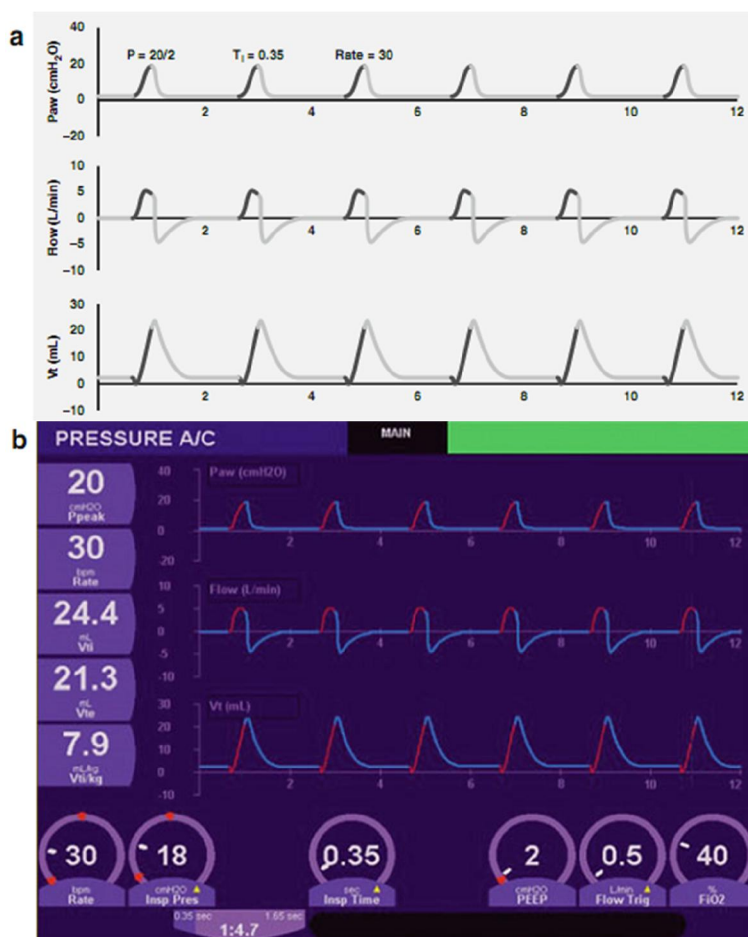
Hình 3.12 Ảnh hưởng của việc giảm PEEP xuống 2 cm H 2 O từ các cài đặt được chỉ ra trong Hình 3.9 (a, sơ đồ; b, thực tế). Điều này làm tăng biên độ trong khi hạ thấp áp lực đường thở trung bình, bởi vì sự gia tăng biên độ, thể tích khí lưu thông cũng tăng.
