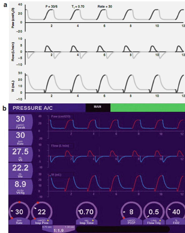
Hình 3.13 Ảnh hưởng của việc kéo dài thời gian hô hấp từ 0,35 đến 0,7 giây (a, sơ đồ; b, thực tế). Khu vực dưới đường cong đã tăng cho thấy áp lực đường thở trung bình cao hơn. Ngoài ra, so với hình 3.11, thể tích phân phối cao hơn, mặc dù PIP và PEEP không thay đổi
