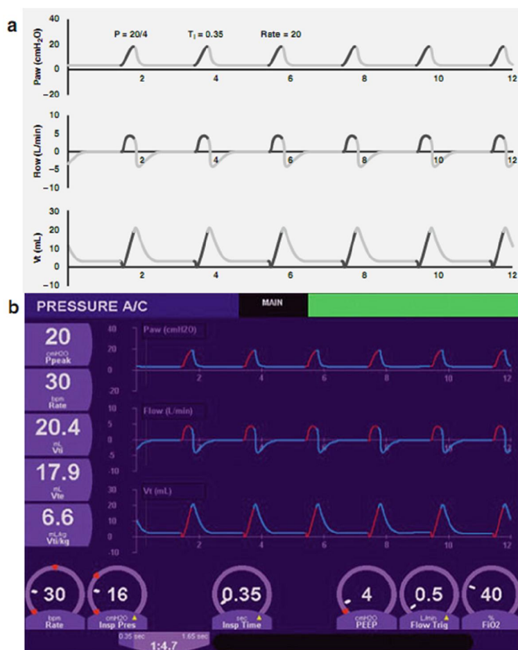
Hình 3.9 Các dạng sóng cơ sở (a, sơ đồ; b, thực tế). Bắt đầu cài đặt PIP 20 cm H 2 O, PEEP 4 cm H 2 O, Ti 0,35 giây và tần số 30 bpm
