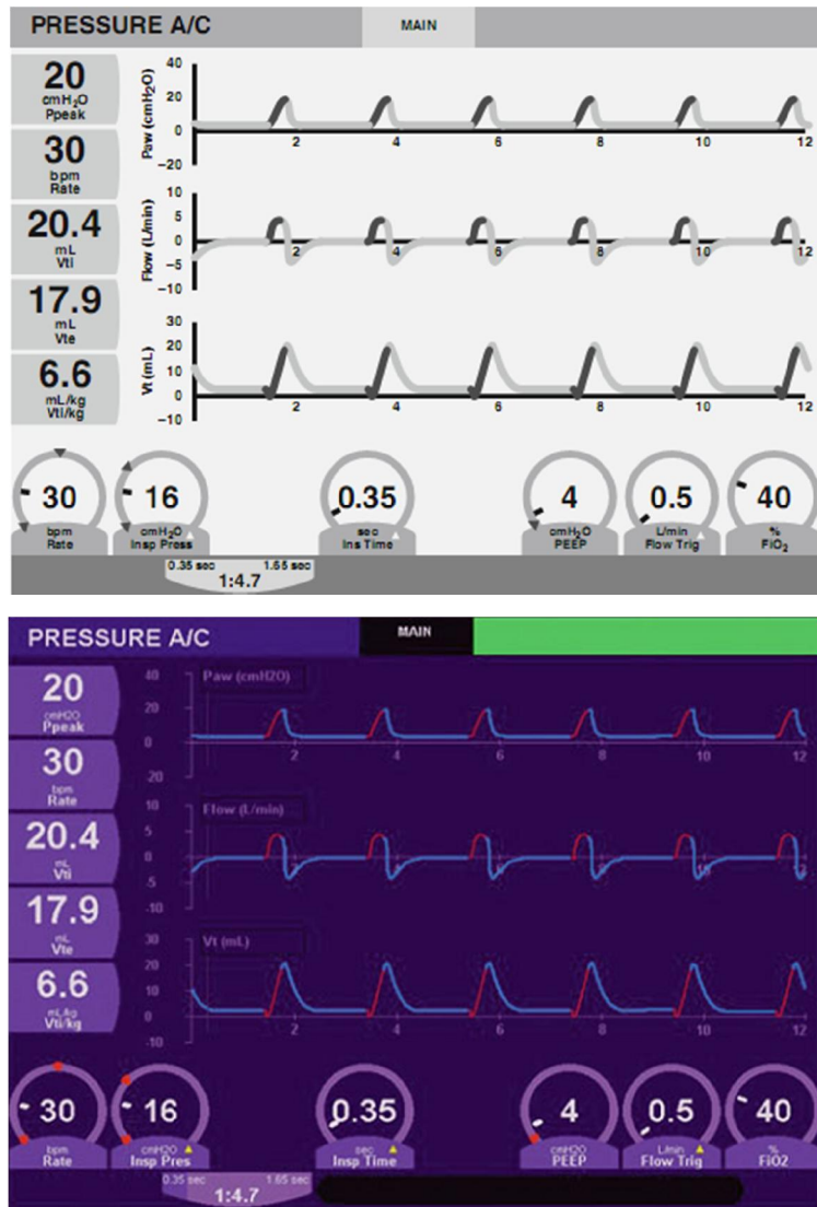
Hình 1.3 Màn hình giám sát đồ họa điển hình (a, sơ đồ; b, thực tế). Trong ví dụ này, áp lực, tần số thở, thể tích hít vào, thể tích thở ra và thể tích hít vào/kg được đo được hiển thị trên trục thẳng đứng; các thông số cá nhân hóa thường có thể tùy chỉnh và các thông số khác có thể được hiển thị. Các tham số được cài đặt bởi người vận hành máy được hiển thị trên trục ngang; trong ví dụ này, chúng bao gồm tần số, áp lực hít vào, thời gian hít vào, PEEP, kích hoạt lưu lượng và FiO 2 . Chúng thường được nhà sản xuất cài đặt và có thể không được thay thế. So sánh kết quả hai nhóm trị số này cho phép người sử dụng để xác định những gì (nếu có) đóng góp của bệnh nhân vào các giá trị hỗ trợ đã cài đặt.
