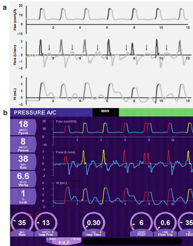
Hình 3.4 Thông khí A/C mục tiêu áp lực (a, sơ đồ; b, thực tế). Trong chế độ này, mỗi lần bệnh nhân hít thở vượt quá độ nhạy hỗ trợ kích hoạt lưu lượng, nhịp thở được nhắm mục tiêu áp lực (nhịp thở assist) đồng bộ được cung cấp (hiển thị bằng màu vàng). Nếu em bé không thở quá mức kiểm soát, hoặc nếu nhịp thở tự phát không đáp ứng được ngưỡng kích hoạt, nhịp thở bắt buộc (nhịp thở control) được cung cấp (có màu đỏ). Lưu ý rằng không phải tất cả các nhịp thở tự phát đều đạt đến ngưỡng kích hoạt và những kết quả không gây ra nhịp thở cơ học (mũi tên)
